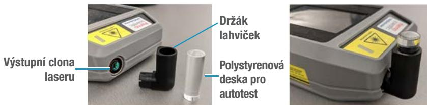
2. Umístěte polystyrenovou desku do držáku lahviček, jak je znázorněno výše. Desku pevně zatlačte do držáku tak, aby laser pronikl do vzorku.
